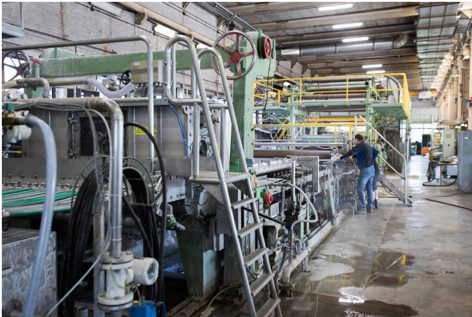
Bij Schut Papier in Heelsum gaf een test met sensoren, die de temperatuur en het vochtgehalte in het papier tijdens het droogproces volgden, aan dat enkele droogcilinders mogelijk onder lagere temperaturen kunnen werken. (Foto: Schut Papier)
